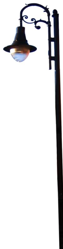
Poste serie ornamental **MILANO**, fabricado con tubo recto de 5 mts de altura caña de 3" ced 30 con placa base de 25 x 25 cms. Y 19 cms entre centros con un sistema para sujetar al poste
